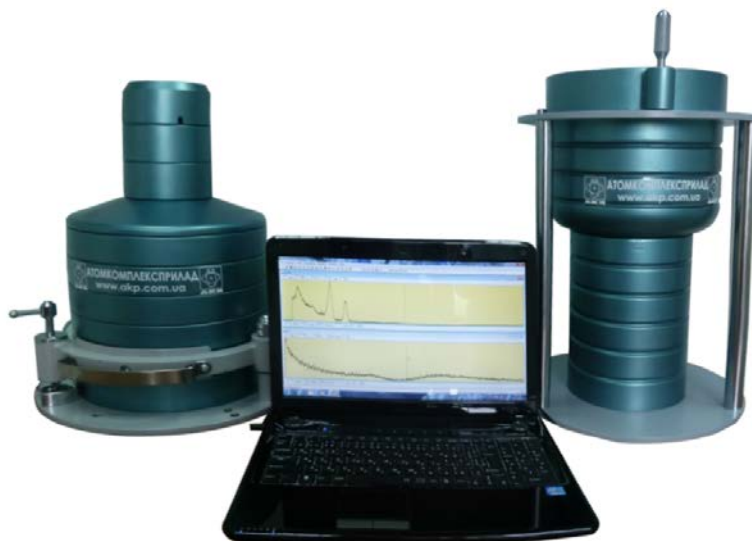
Рис. 2. Сцинтиляційні спектрометри енергій бета-гамма-випромінювань типу СЕБ-01 та СЕГ-001.
