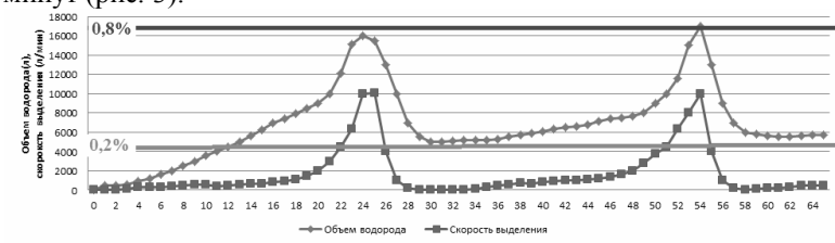
Рис. 3. Результаты моделирования – объем и скорость выделения водорода
