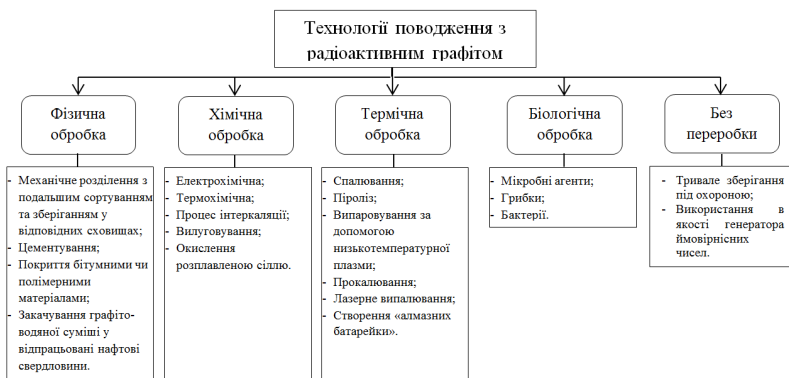
Рис. 2. Систематизація технологій поводження з радіоактивним графітом
