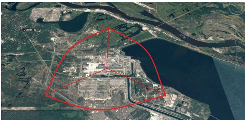
Рис. 9. Зона покриття БС (LTE) на території Чернобыльської атомної електростанції
