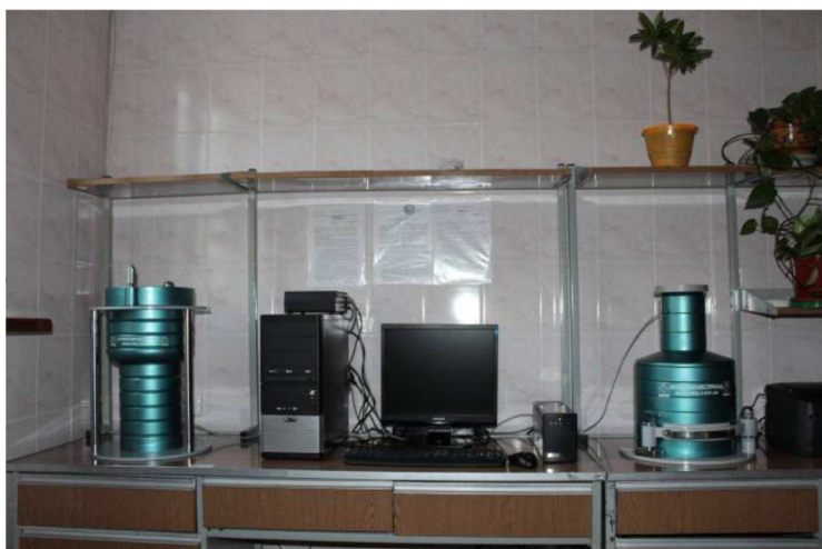
Рис. 2. Сцинтилляционные спектрометры энергий бета-гамма-излучений типа СЕБ-01 и СЕГ-001
