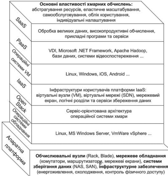
Рис. 2. Структура архітектури хмарної платформи
