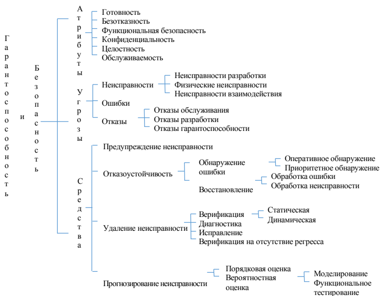
Рис. 1. Дерево гарантоспособности и безопасности
