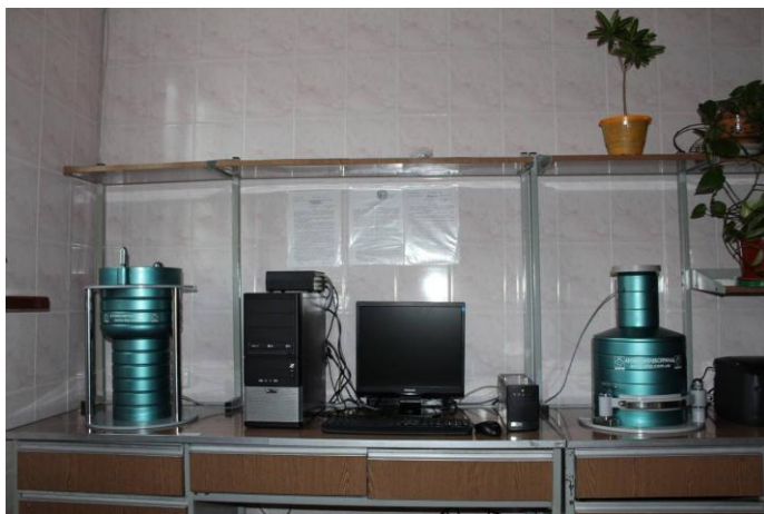
Рисунок 2. Сцинтилляционные спектрометры энергий бета-гамма-излучений типа СЕБ-01 и СЕГ-001.
