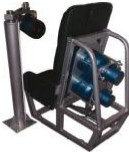
Рисунок 3 – Спектрометр випромінювання людини «СИЧ-АКП-3»
