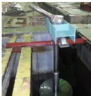
Рисунок 29 – Адаптер А-ХОЯТ зафиксированный съемным ограничителем
