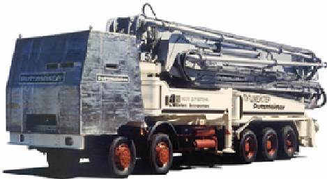
Рисунок 18 – Бетононасос марки «Putzmeister»
