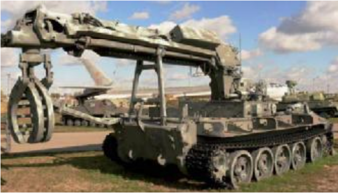
Рисунок 10 – Инженерная машина разграждения
